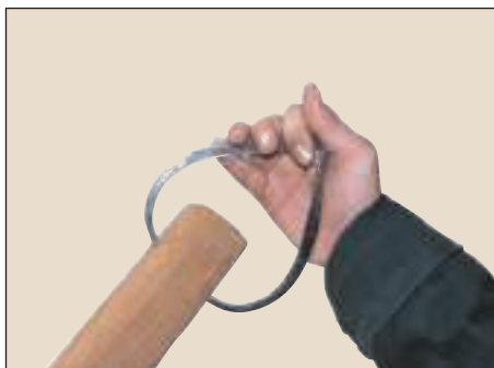
Fig. 2.40. Măsurarea dimensiunilor exterioare ale unei piese rotunde.
