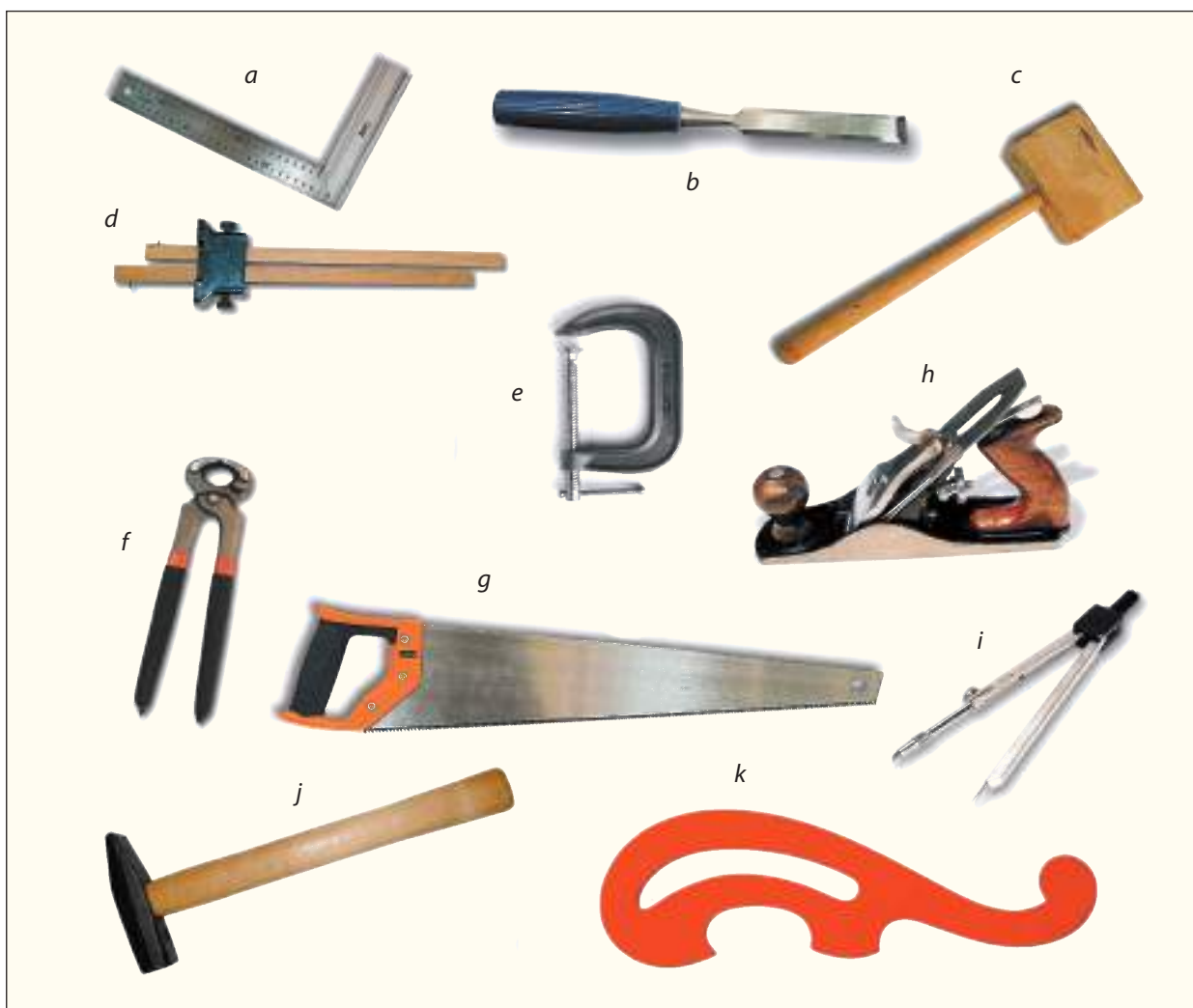
Fig. 2.35. Instrumente necesare la prelucrarea materialelor lemnoase: a – echer (sau colțar); b – daltă de tâmplărie; c – ciocan de lemn; d – trasator paralel (ac de trasat sau zgârieci); e – menghină; f – clește de scos cuie; g – fierăstrău; h – rindea; j – ciocan; i – compas; k – florar.
