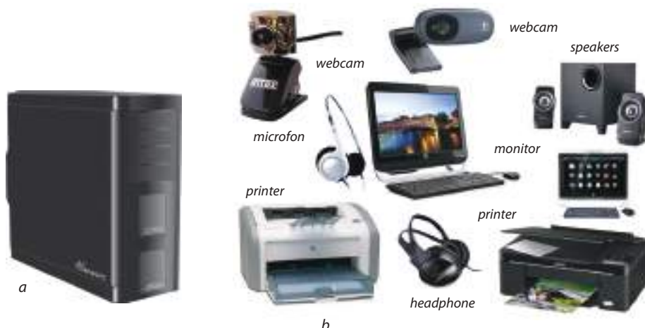
Fig. 5.1. Elementele principale hardware sunt: a – unitatea centrală, b – dispozitive periferice.
