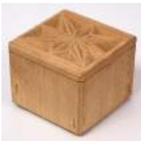
Fig. 2.56. Lădiță asamblată prin încheiere și scoabe.
