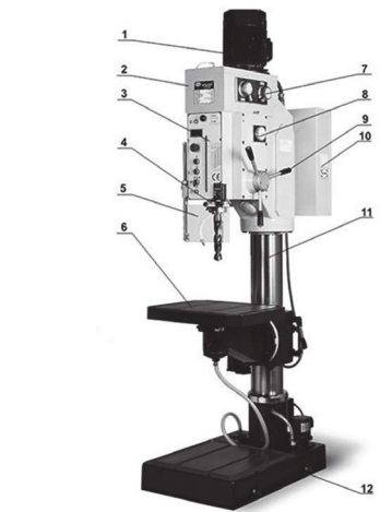
Fig. 18. Părțile componente ale unei mașini de găurit staționare: 1 – motor electric; 2 – cutie de viteze; 3 – panou de comandă; 4 – axul principal cu mandrină; 5 – protector transparent; 6 – masă; 7 – manete de schimbare a vitezelor; 8 – maneta de comandă a filetării; 9 – volantul avansului axului principal; 10 – panou electric; 11 – coloană; 12 – batiu
