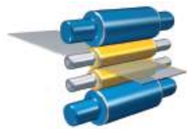
Fig. 23. Principiul de funcționare a laminorului cu patru cilindri
