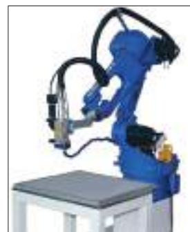
Fig. 4. Robot industrial de sudare cu laser, 6 axe
