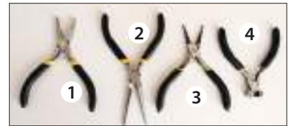
Fig. 20. Clești pentru lucru cu sârma: 1 - cu fălci plate; 2 - cu fălci plate îngustate; 3 - cu fălci rotunde și conice pe lungime; 4 - clește tăietor
