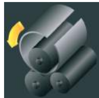
Fig. 27. Schema de principiu a mașinii de roluire a cilindrilor
