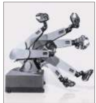
Fig. 4. Primul robot cu șase axe acționate electromecanic, 1973
