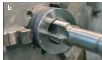
Fig. 13. Procedul de tăiere a filetului interior cu tarodul: a – manual; b – la strung
