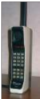
Fig. 6. Motorola DynaTAC 8000X, unul dintre primele telefoane mobile care funcționa în sistem analogic
