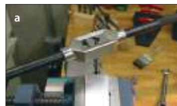
Fig. 12. Tarozii: a – de mașină; b – pentru piulițe; c – pentru filet cilindric; d – pentru filet conic
