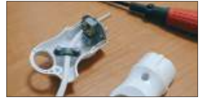
Fig. 11. Conectarea cablului de alimentare la o fișă de curent electric
