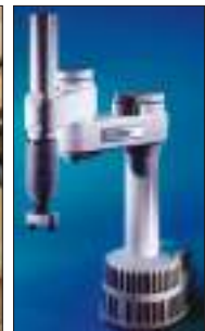
Fig. 8. Primul robot SCARA cu acționare directă, 1984
