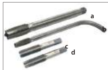
Fig. 12. Tarozii: a – de mașină; b – pentru piulițe; c – pentru filet cilindric; d – pentru filet conic
