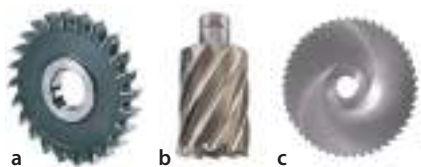
Fig. 9. Freze: a – freză-disc; b – cilindrică; c – de retezat
