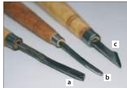
Fig. 5. Dălțițe: a - cu tăiș în formă de V; b - cu tăiș în formă de U; c - cuțit cu tăiș oblic
