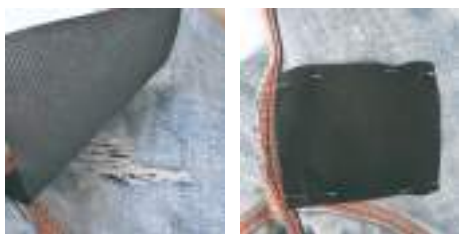
Fig. 34. Repararea unei rupturi prin peticire
