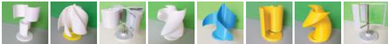
Fig. 31. Modele de turbine eoliene elaborate la Universitatea Tehnică a Moldovei, executate cu ajutorul imprimantelor 3D
