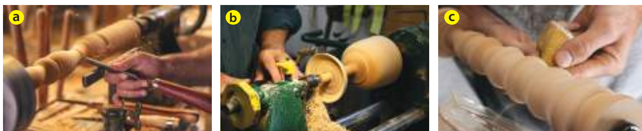
Fig. 26. Procedee de strunjire: a – pe exterior; b – pe interior; c – șlefuire
