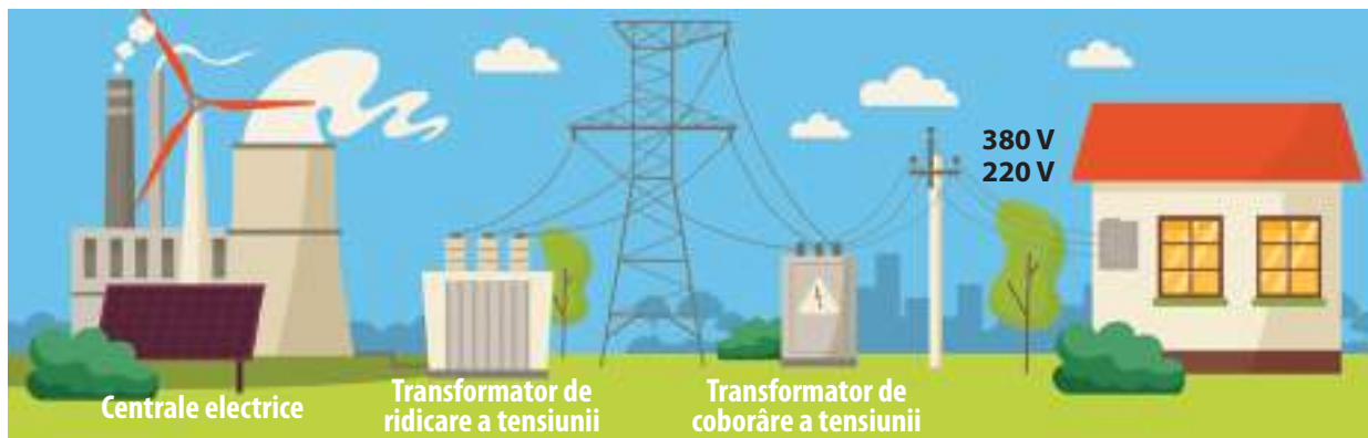
Fig. 8. Schema de principiu a unei rețele electrice
