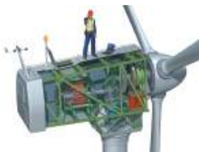
Fig. 3. Turbină eoliană: paletetele rotorului, axa rotorului, generatorul
