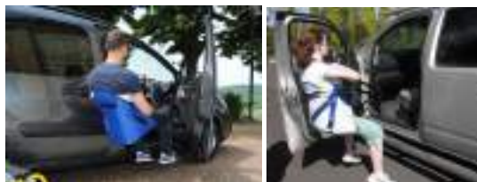
Fig. 10. Dispozitive pentru accesul în automobil al persoanelor cu dizabilități locomotoare
