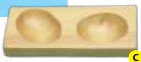
Fig. 13. Cioplirea suprafețelor curbe: a, b – trasarea liniilor curbe și tăierea pe liniile 1-3 și 2-4; degajarea primară a lemnului din interiorul conturului; c – suprafețe curbe definitive
