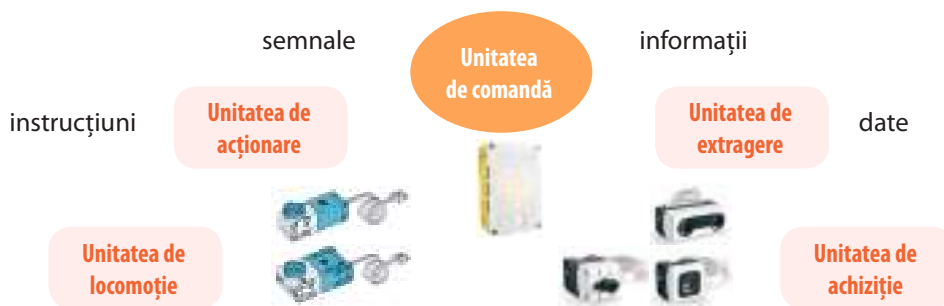
Fig. 28. Schema funcțională a robotului
