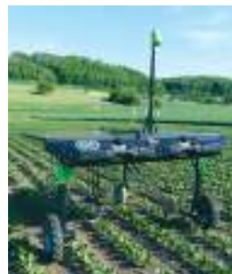
Fig. 9. Robotul Ecorobotix pentru înlăturarea buruienilor din câmpurile cu legume
