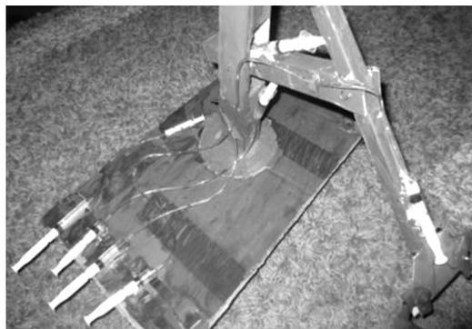
Рис.2. Функциональный макет гидравлического крана
